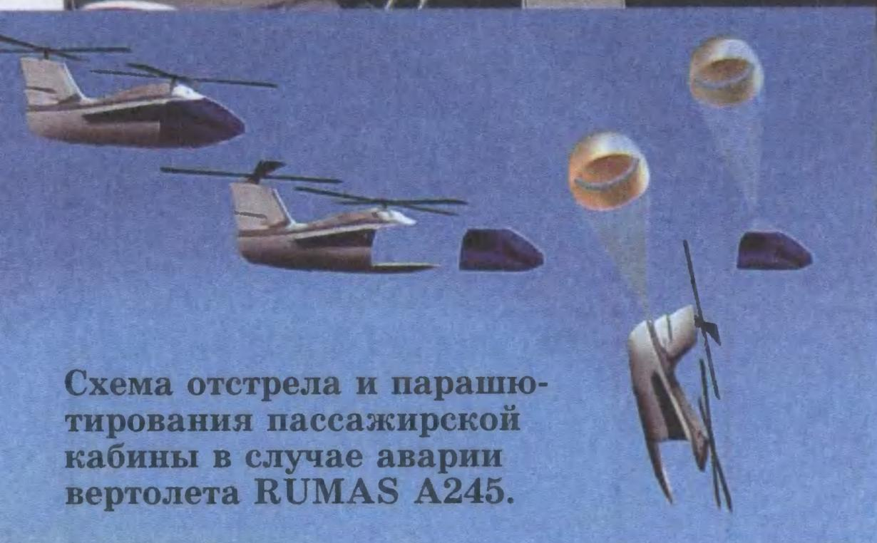
Схема отстрела и парашютирования пассажирской кабины в случае аварии вертолета RUMAS A245.
